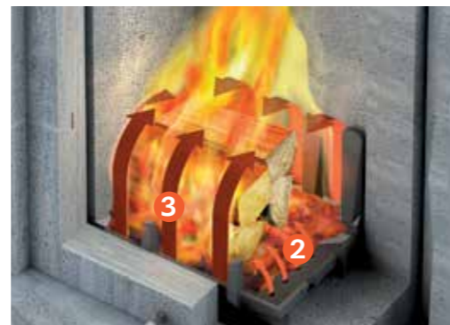
Das Holzabbrandssystem "Goldenes Feuer" mit Umsetzung in Gas, Patent Nr. EP1008808
